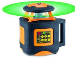
Рисунок 1 – Нівелір лазерний ротаційний з сервоприводним горизонтуванням візирної осі
